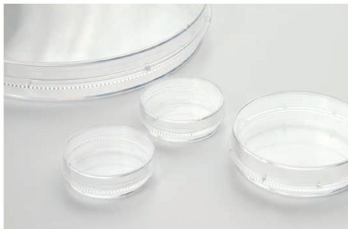
グリップの上のノッチにより、フタと受け皿は接触しない構造になっています。
